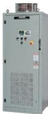
Преобразователь частоты шкафного исполнения для промышленных систем водоснабжения и канализации с запатентованной компанией Toshiba 18-пульсной схемой с автотрансформатором, позволяющей осуществлять управление двигателем без искажения питающей сети.
