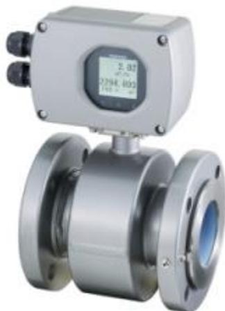
Электромагнитные расходомеры серии GF630 фланцевого исполнения предназначены для измерения расхода токо-проводящих жидкостей с диаметром условного прохода до 600 мм при скорости потока до 10 м/с.
