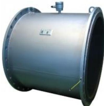
Электромагнитные расходомеры серии GF642 больших размеров предназначены для измерения расхода токо-проводящих жидкостей с диаметром условного прохода от 500 до 1950 мм.
