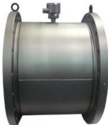
Электромагнитные расходомеры серии LF664 больших размеров предназначены для измерения расхода токо-проводящих жидкостей с диаметром условного прохода от 500 до 1950 мм, при минимально допустимом расстоянии до ближайшего разветвления любого типа 1.6D.
