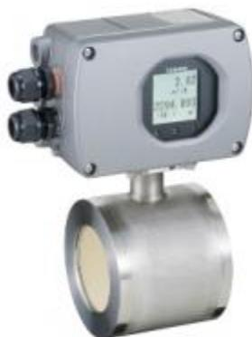
Электромагнитные расходомеры серии LF410 бесфланцевого исполнения, предназначены для измерения расхода токо-проводящих жидкостей с диаметрам условного прохода до 200 мм, с минимально допустимым расстоянием до разветвления 1.6D.
