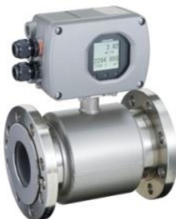
Электромагнитные расходомеры серии LF430 фланцевого исполнения, предназначены для измерения расхода токо-проводящих жидкостей с диаметром условного прохода до 600 мм, с минимально допустимым расстоянием до любого разветвления 1.6D.
