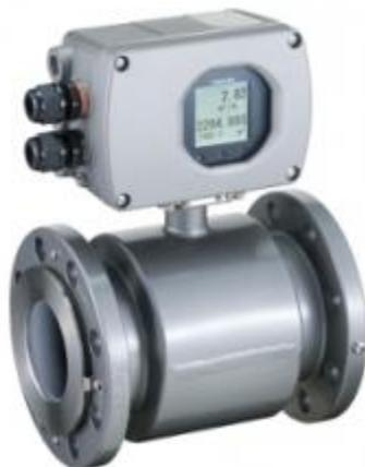
Электромагнитные расходомеры серии LF650 фланцевого исполнения, предназначены для измерения расхода токо-проводящих жидкостей с диаметром условного прохода до 450 мм, с минимально допустимым расстоянием до любого разветвления 1.6D.
