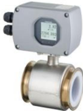
Электромагнитные расходомеры серии LF490 исполнения с санитарно-техническими зажимами, предназначены для измерения расхода токо-проводящих жидкостей с диаметрам условного прохода до 100 мм, с минимально допустимым расстоянием до разветвления 1.6D. Диаметры условного прохода:
